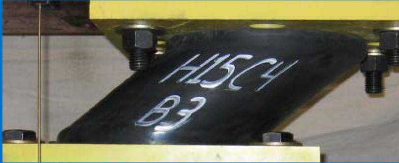
Le piastre in acciaio non si deformano lateralmente quindi ognuno dei  $n$  strati di gomma e' soggetto alla stessa forza  $F$  e si deforma di  $x_{strato} = X/n$
