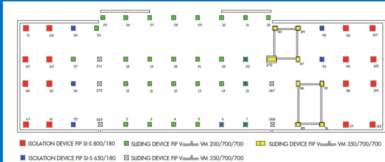
Fig. 3.9.6: Posizionamento degli isolatori elastomerici e dei dispositivi a slitta
