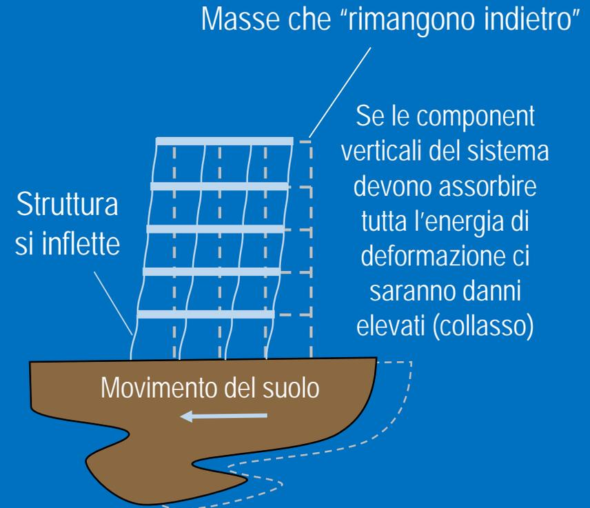
La progettazione sismica tradizionale usa elementi sacrificali, come telai (MRF), pareti di taglio, diagonali ecc. Questi elementi si danneggiano ma prevengono il collasso
