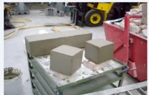
Con riferimento al metodo di prova normalizzato, ai sensi della UNI EN 13295 i tre provini sono stati introdotti in una camera di carbonatazione accelerata ed esposti per 90 giorni ad un'atmosfera contenente l'1% di CO<sub>2</sub> ad una temperatura di 22°C e umidità relativa del 65%.
