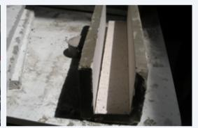
Immagini delle lastre rimosse dalle superfici laterali di un provino prismatico non protetto (a sinistra), un provino prismatico protetto con la finitura acrilica AC 515 (al centro) ed un provino prismatico protetto con il rivestimento cementizio CM 519 (a destra).
