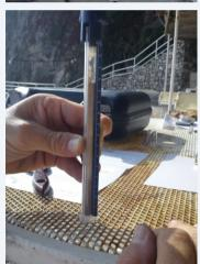
La polvere di perforazione è stata raccolta sul fondo di una provetta ed analizzata con la fenolftaleina, individuando così il punto di passaggio tra la polvere carbonatata e la polvere alcalina.
