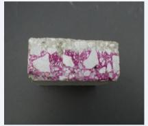
Ciascuna superficie di rottura fresca è stata trattata con una soluzione indicatrice a base di fenolftaleina che colora in rosa-violetto le zone non carbonatate e lascia incolori quelle carbonatate.
