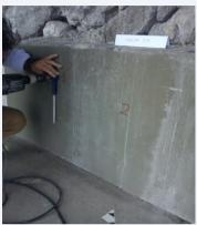
Utilizzando un comune trapano a percussione con punta per muratura del diametro di 10 mm, sono state eseguite 6 perforazioni per ogni pannello del muretto sottoposto ai trattamenti di ripristino con i prodotti appena richiamati.
